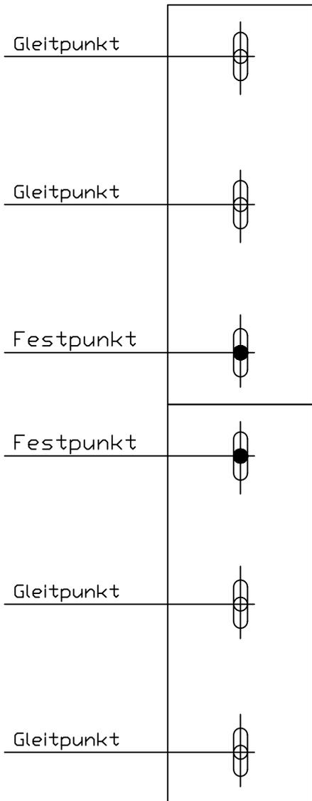
Montage von Pegellatten, bestehend aus: 3 Teilstücken
